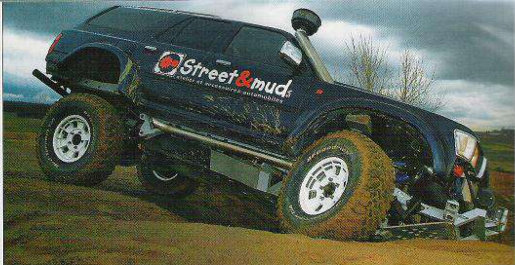
La géométrie des suspensions à l'arrière autorise une légère rotation du pont arrière et braque même légèrement les roues. À noter également le blindage inférieur au niveau du châssis.
