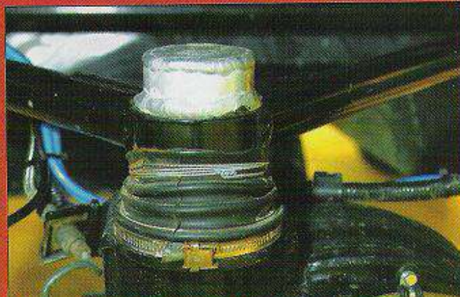
▲ Gros plan sur le point d'ancrage du pont et du trapèze de suspension arrière.
