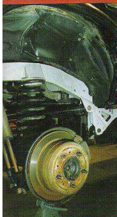
▲ La suspension arrière, bien visible avec ses deux amortisseurs entièrement réglables.
