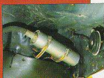
▲ L'une des bonbonnes de l'amortisseur avant est située dans le passage de roue.
